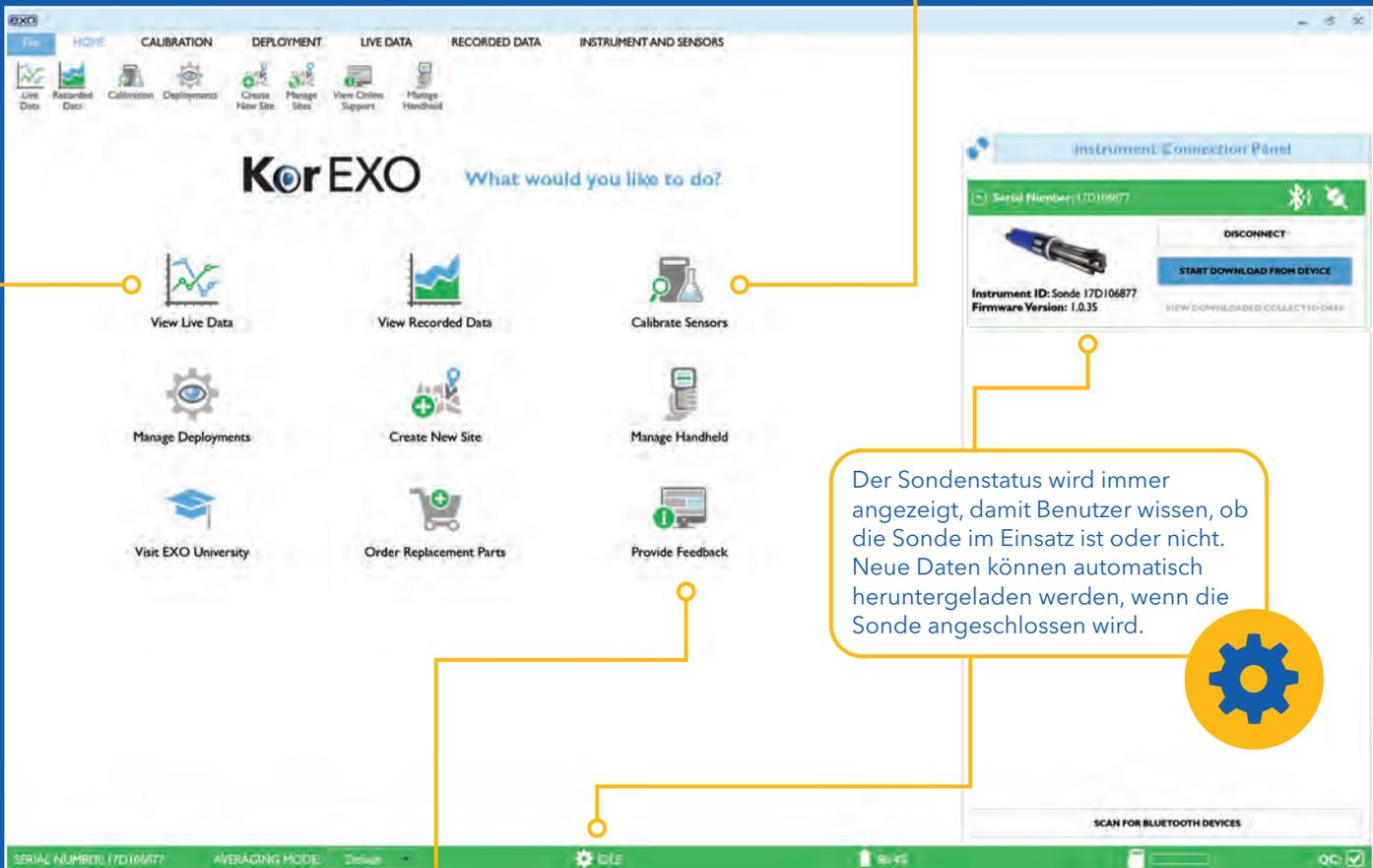
Der Sondenstatus wird immer angezeigt, damit Benutzer wissen, ob die Sonde im Einsatz ist oder nicht. Neue Daten können automatisch heruntergeladen werden, wenn die Sonde angeschlossen wird.
